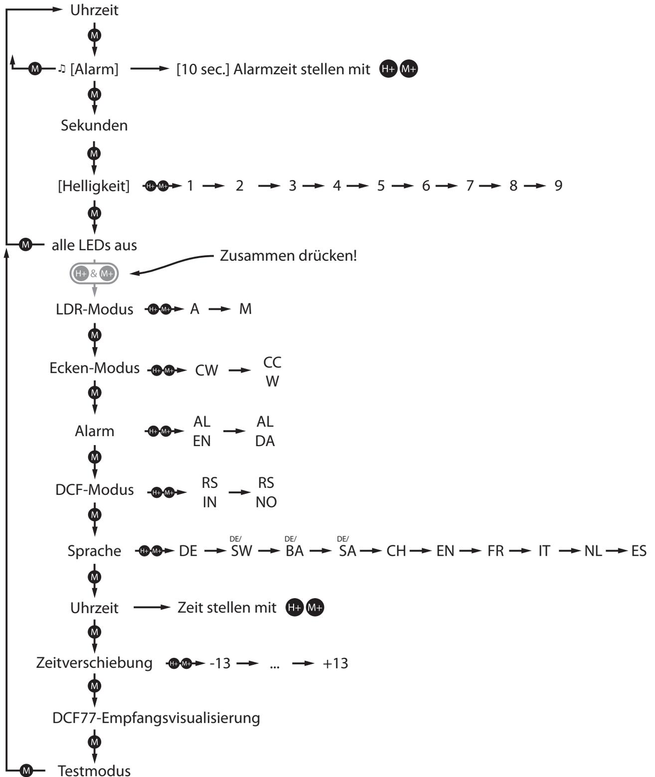
Die eingestellte Uhrzeit wird gegebenenfalls durch den DCF77-Empfänger korrigiert. Ohne Empfang läuft sie über die Quarzuhr (Echtzeituhr).
